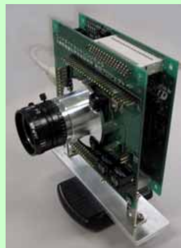
高ダイナミックイメージセンサ と搭載したカメラ(製品化予定)
