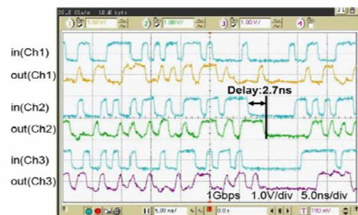
図7 LWI 伝送特性実測結果
